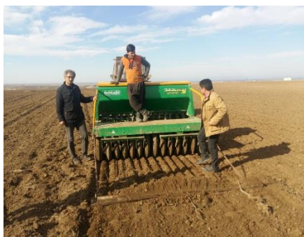
شکل ۱- تصویری از بذرکار کاشت مستقیم (سمت چپ) و عمیق‌کار غلات مورد استفاده (سمت راست)
