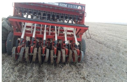
شکل ۱- تصویری از بذرکار کاشت مستقیم (سمت چپ) و عمیق‌کار غلات مورد استفاده (سمت راست)
