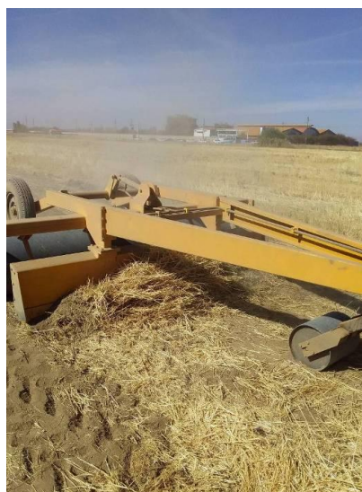
شکل ۵- جمع شدن کاه و کلش گندم در جلوی ماشین تسطیح کن غلتک دار
